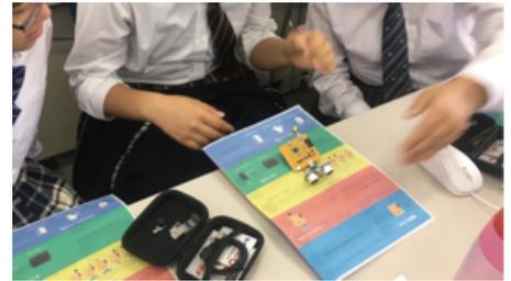
通常、センサーや、マイコンボードを扱うときは、電源タップやコンセントを必要とするのですが、電池で動くようにしてあるので、机の上が整頓された状態で行えるようにした。
